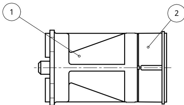
補強ピン+塗代カバー用スペーサー組み付け参考図
